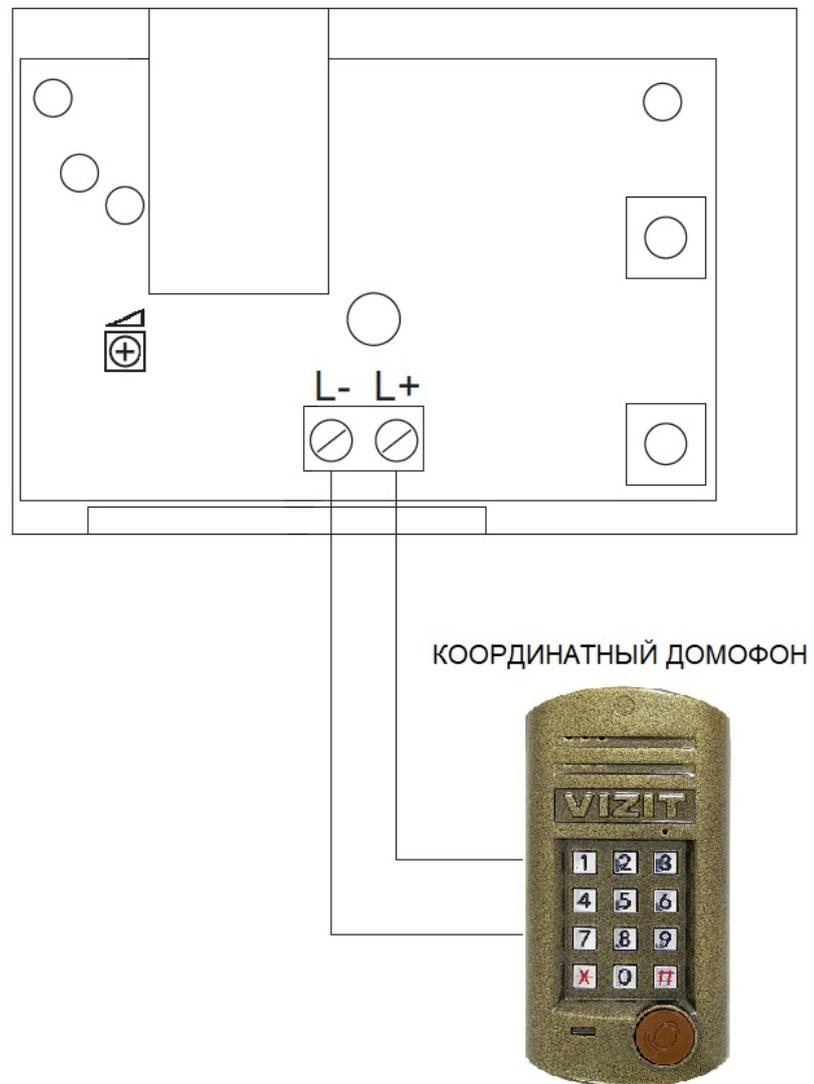
Для координатного домофона адрес устройства настраивать не нужно, так как он определяется коммутатором домофонной системы, достаточно просто подключить линию подъездного домофона на соответствующий вход трубки FE-12M.
